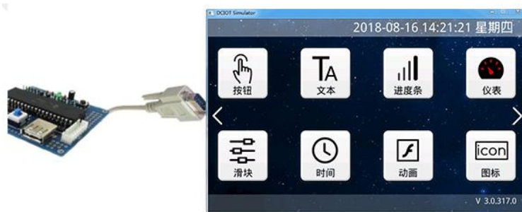
图 11-2 用户单片机串口与“虚拟串口屏”联机调试
