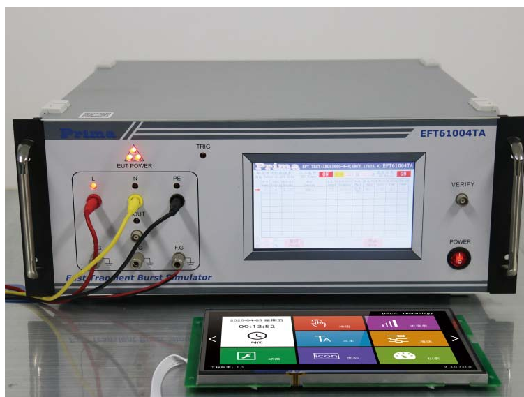
图 3-4 群脉冲测试图
