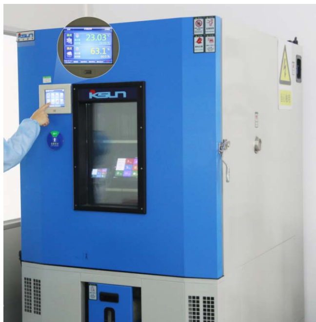
图 3-3 高低温老化测试图
