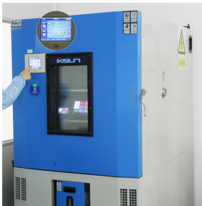
图 4-3 高低温老化测试图
