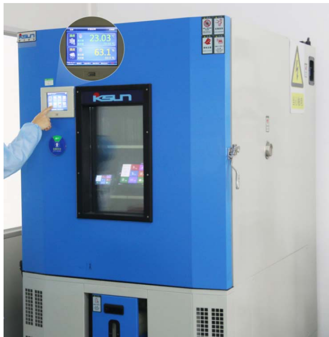
图 3-3 高低温老化测试图
