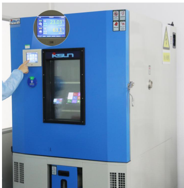
图 5-3 高低温老化测试图
