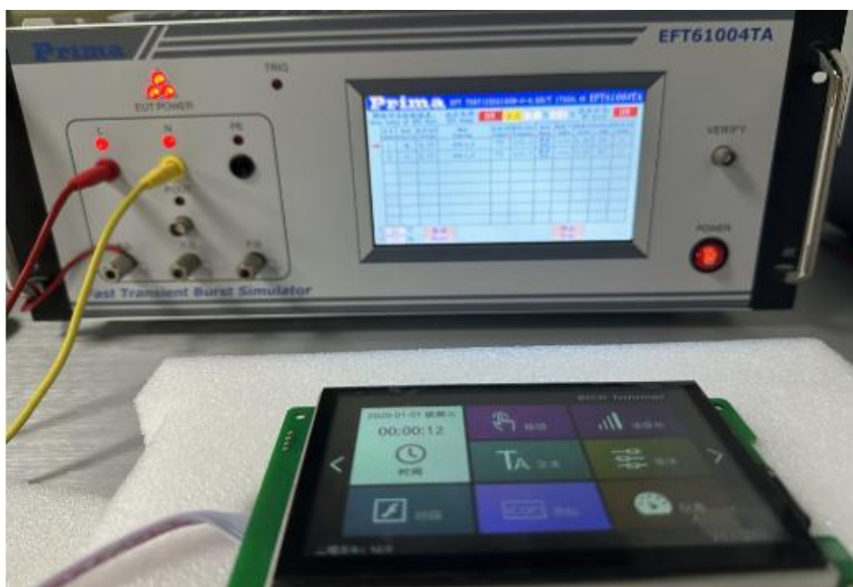
图 5-4 群脉冲测试图
