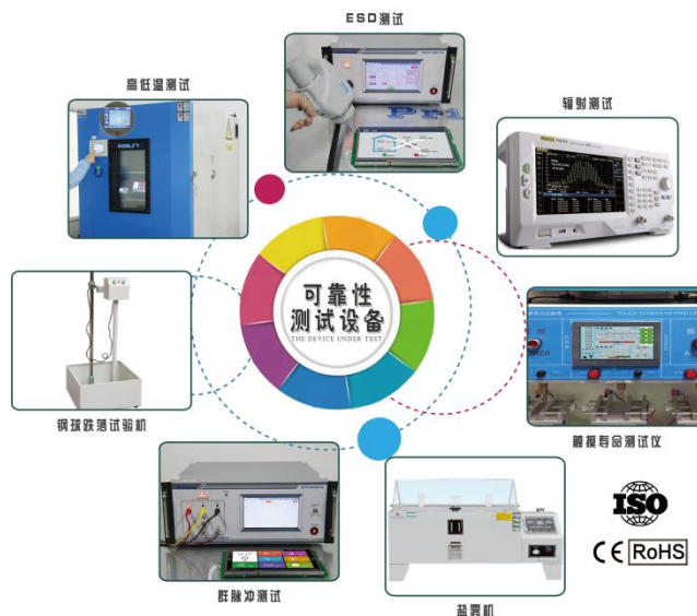
图 3-1 可靠性测试设备
