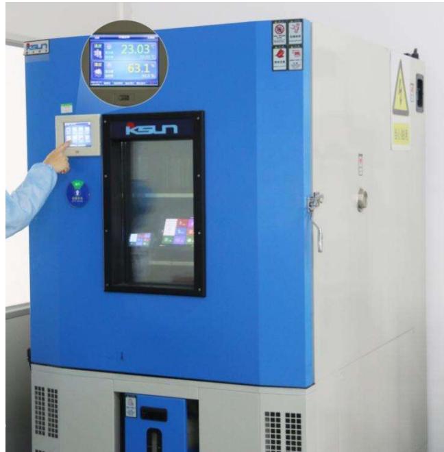
图 4-7 高低温老化测试图
