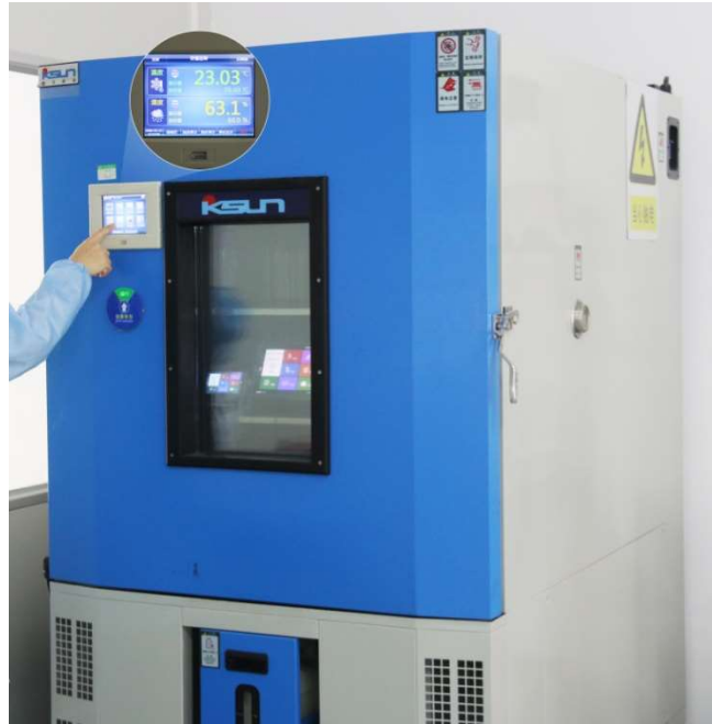
图 4-7 高低温老化测试图
