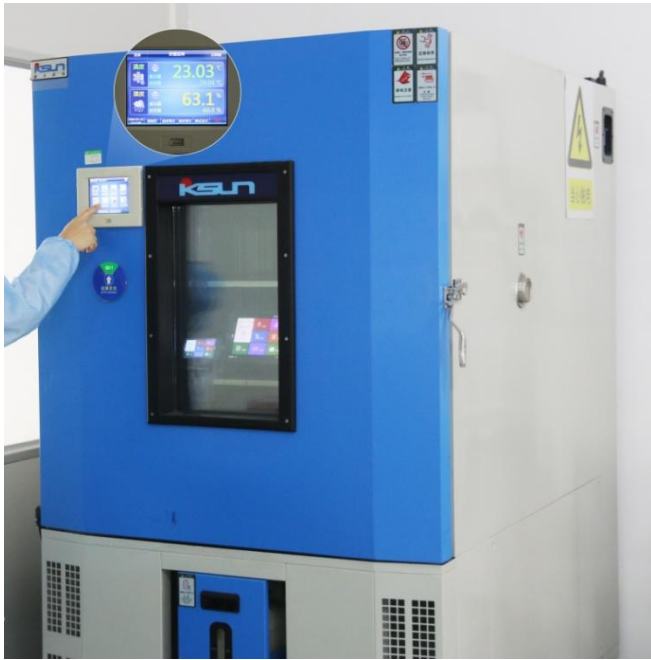
图 5-7 高低温老化测试图
