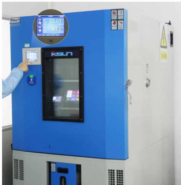
图 4-4 高低温老化测试图
