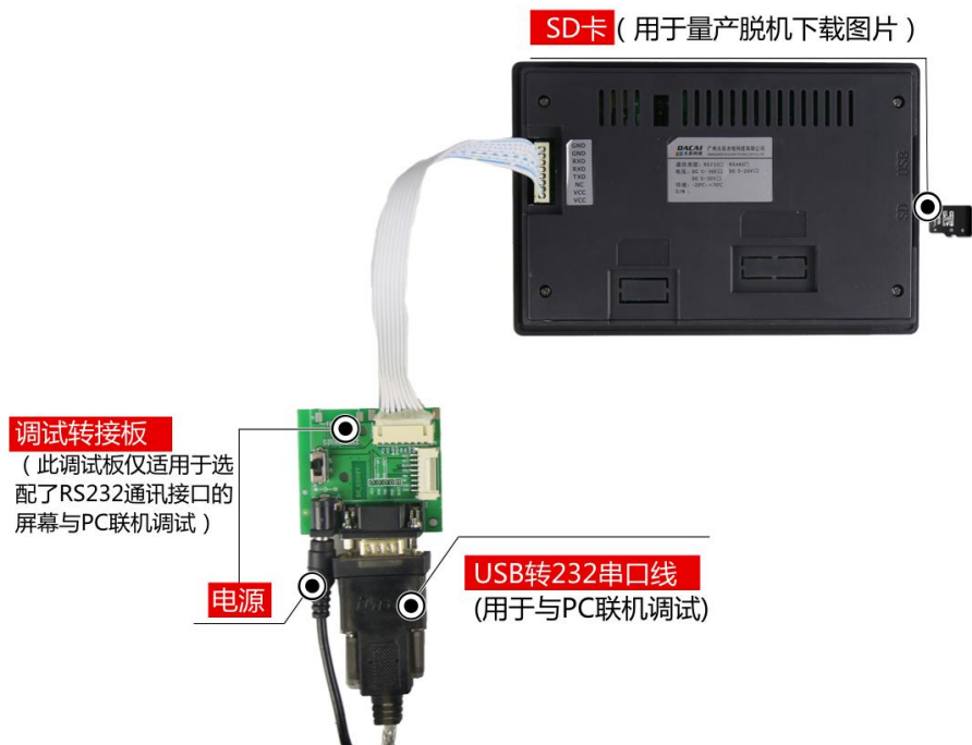
图 1-4 RS232 调试工具图
