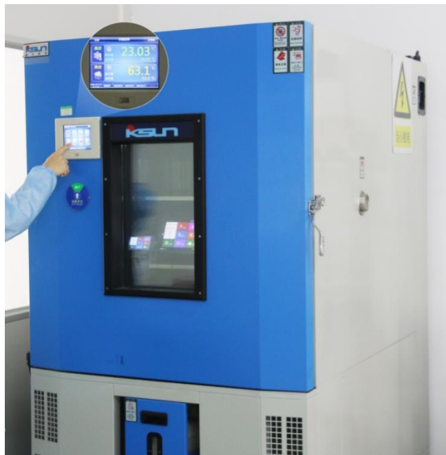
图 4-7 高低温老化测试图
