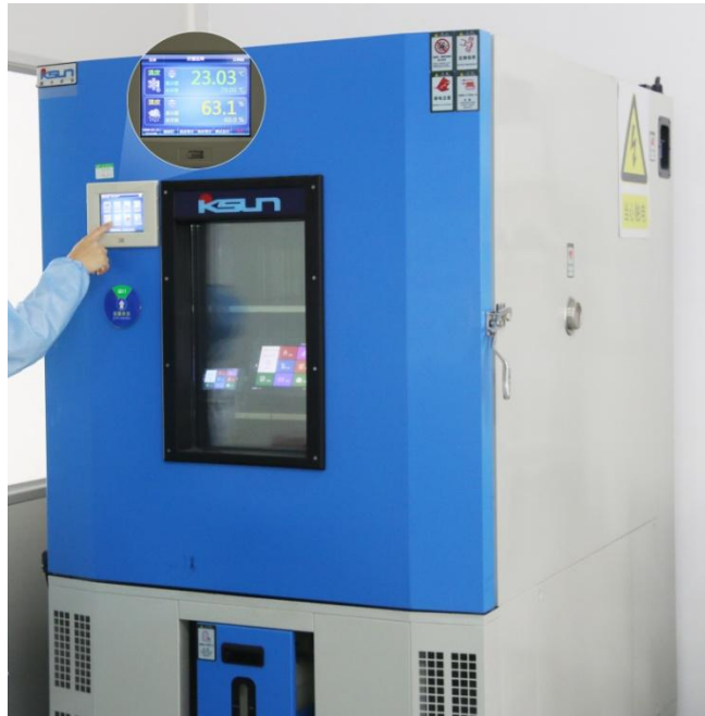
图 4-7 高低温老化测试图
