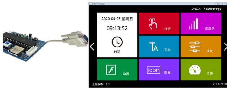
图 6-2 用户单片机串口与“虚拟串口屏”联机调试
