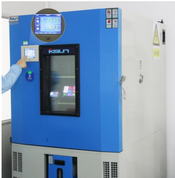
图 4-4 高低温老化测试图
